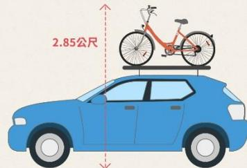
車頂式：高度(含置放架)不超過全寬的1.5倍
